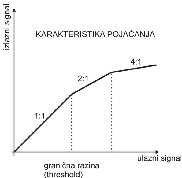
Slika 3.45 Karakteristika pojačanja kompresora.
