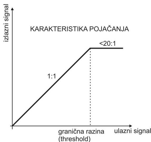
Slika 3.42 Karakteristika pojačanja limitera.
