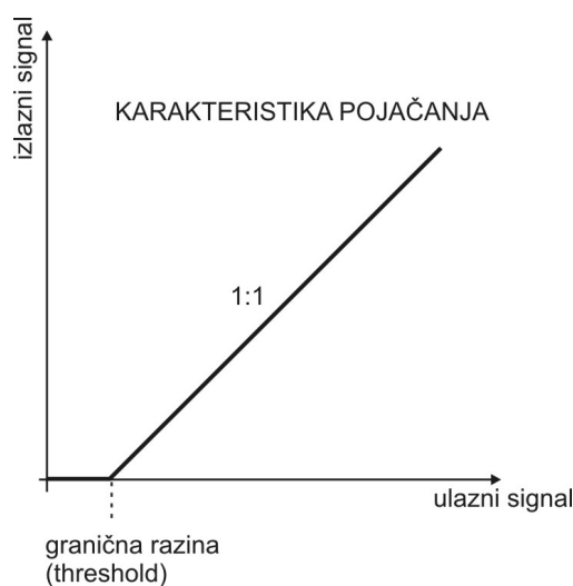
Slika 3.44 Karakteristika pojačanja noise gate uređaja.
