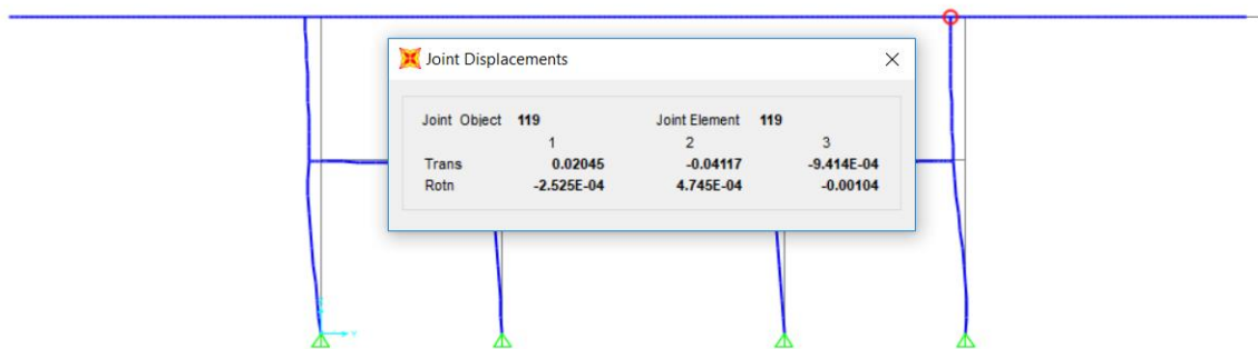
Slika 139. Bočni pomak okvira modela a od kombinacije POTRES GSU.
