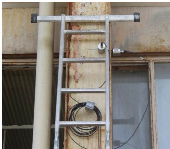
Slika 45. Akcelerometri na visini 5 m.
