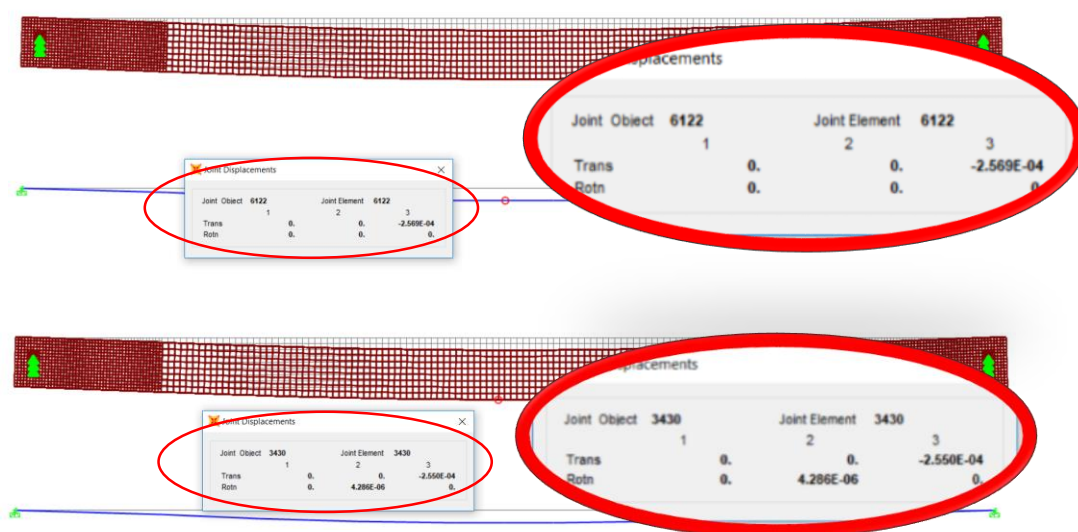
Slika 90. Usporedba progiba od stalnog opterećenja IPN400 grede spojene kao na građevini i štapnog modela s oprugom.
