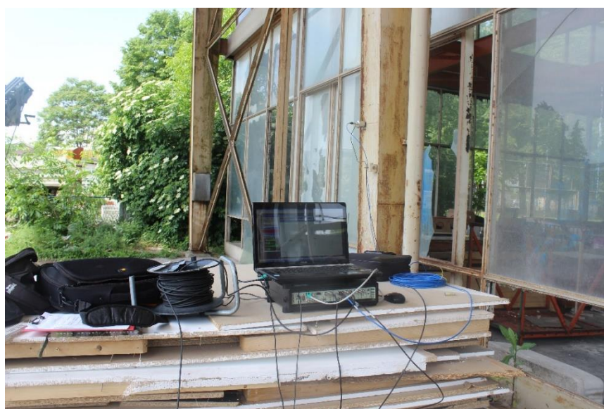
Slika 44. Ispitivanje dinamičkih parametara konstrukcije.
