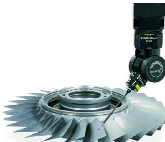
Slika 3.25. Kontaktno skeniranje [Renishaw, 2016]
