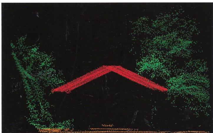
Slika 6. Primjer klasifikacije dijela područja Skradinskog buka u tri klase: visoka vegetacija, građevina i teren
