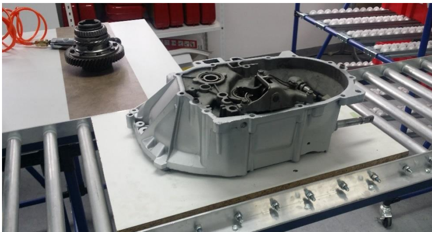
Slika 6.9. Glava mjenjačke kutije na pokretnoj traci
