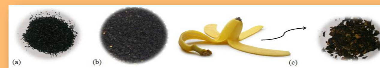
Slika 4. Korišteni adsorbensi: aktivni ugljik (a), modificirana komina masline (b) i kora banane (c).
