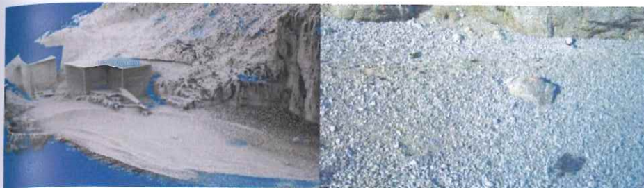
Slika 10. Trodimenzionalni oblak točaka žala Klančac (čitavo žalo i detalj na tijelu žala) mjereni pomoću 3D skenera FARO
