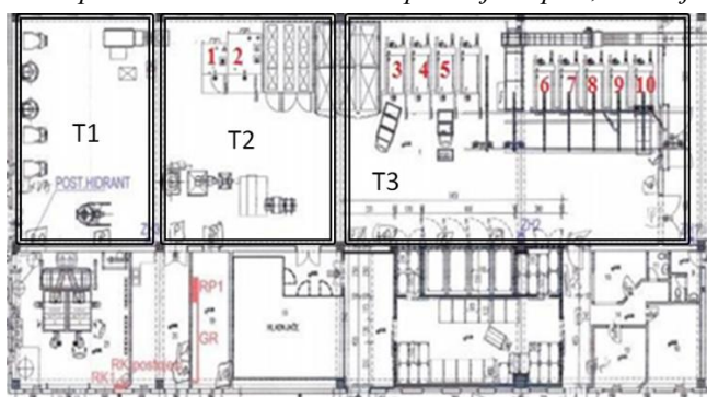
Grafikon 1: Tlocrt proizvodne hale s ucrtanim položajima peći, od broja 1 do broja 10
