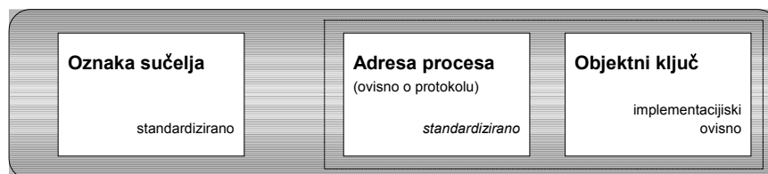
Slika 2.13. Struktura objektne reference
