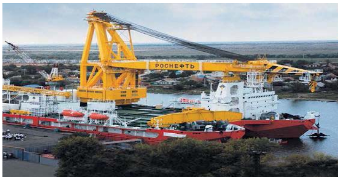
Slika 8. Katamaranska dizalica podizne moći 12.000 kN
