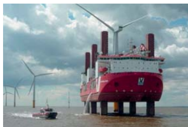
Slika 22. Jedan od najvećih brodova u svijetu za instalaciju vjetroturbina
