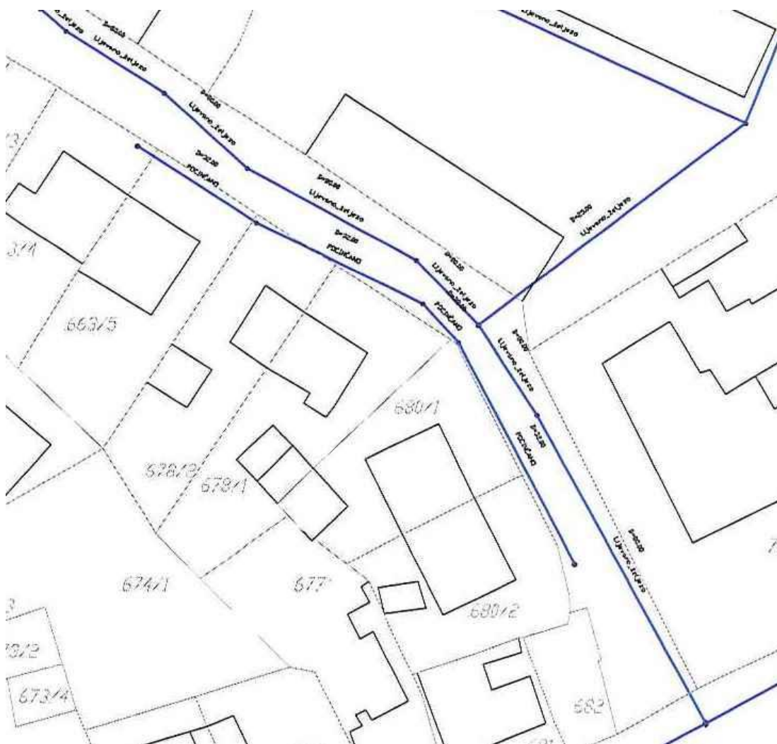
Slika 4. Skica vodovodnih cijevi u ulici Imbre Tkalca (izvor: službeni podaci tvrtke Vodovod i kanalizacija d.o.o.)
