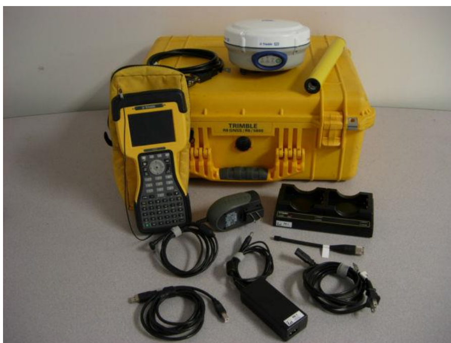
Slika 11. GPS uređaj Trimble R8 (izvor: URL3)
