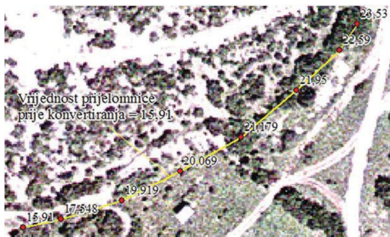
Slika 2. Primjer konvertiranja linija, odnosno lomnih točaka u pojedinačne točke sa Z vrijednostima
