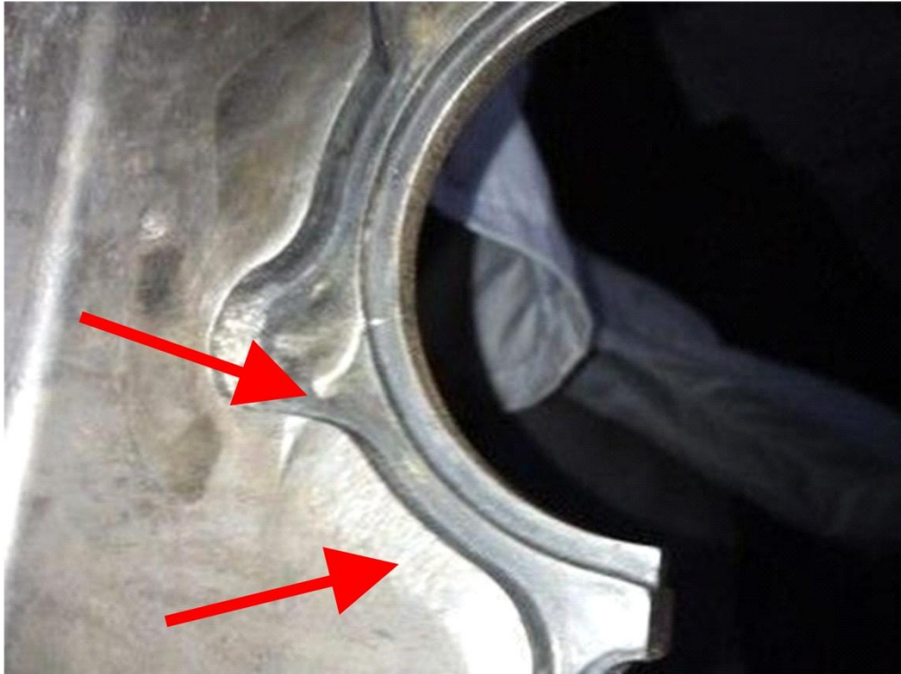
Slika 8. Trošenje materijala kalupa pri procesu lijevanja - primjer 3 [1]
