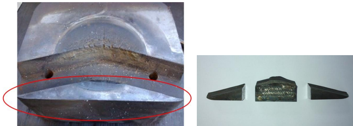
Slika 23. Prikazi mjesta uzimanja uzoraka s alata i izrezanih uzoraka
