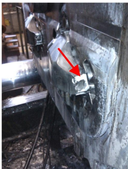
Slika 15. Primjeri popravka alata elektro - metalizacijom [1]
