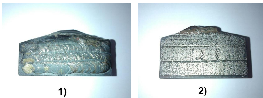
Slika 24. Prikaz središnjeg uzorka materijala sa sprovedenim postupcima popravaka: 1) TIG navarivanjem, 2) elektro - metalizacijom
