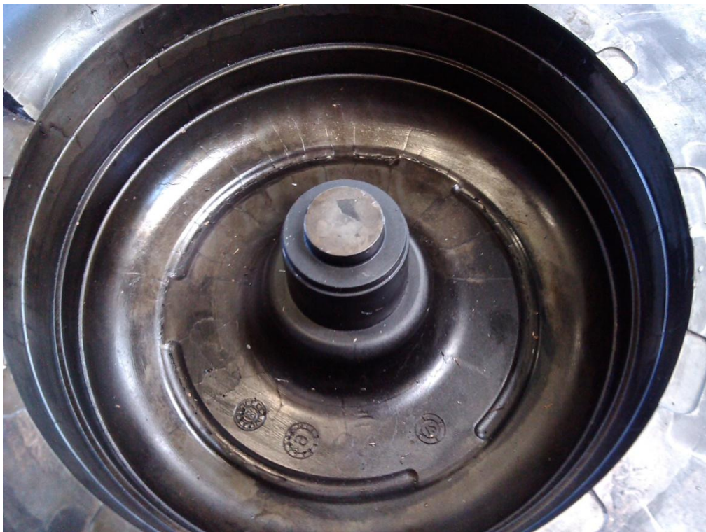
Slika 9. Trošenje materijala kalupa pri procesu lijevanja - primjer 4 [1]
