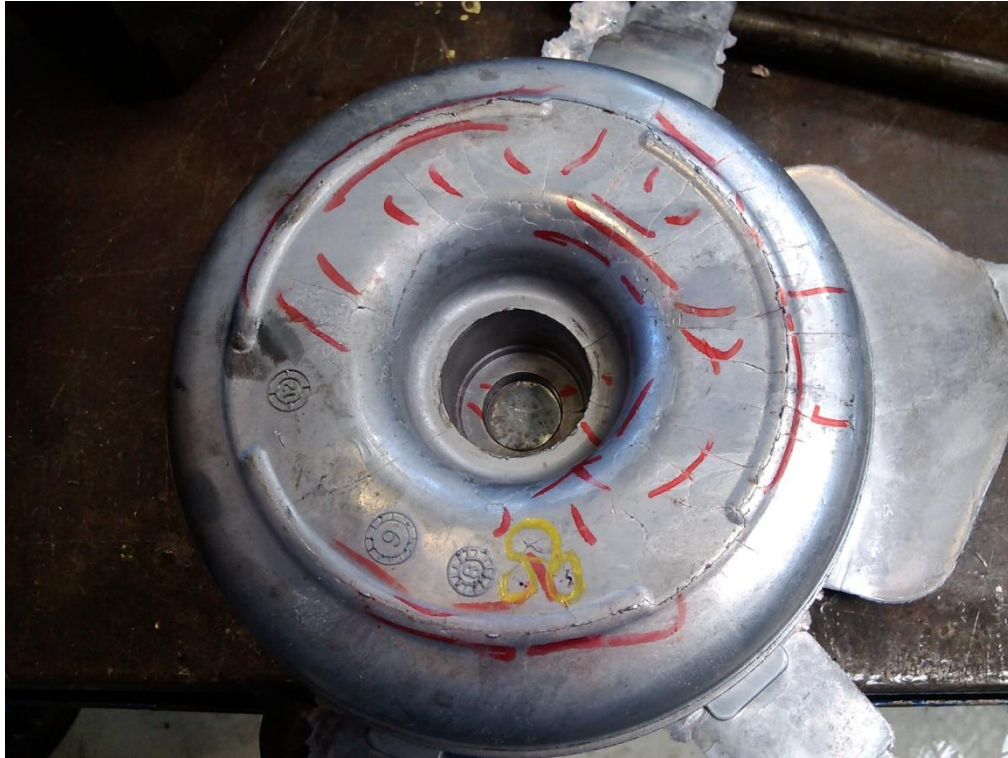
Slika 10. Izgled površine odljevka izlivenog u kalupu sa slike 9 (primjer 4) [1]
