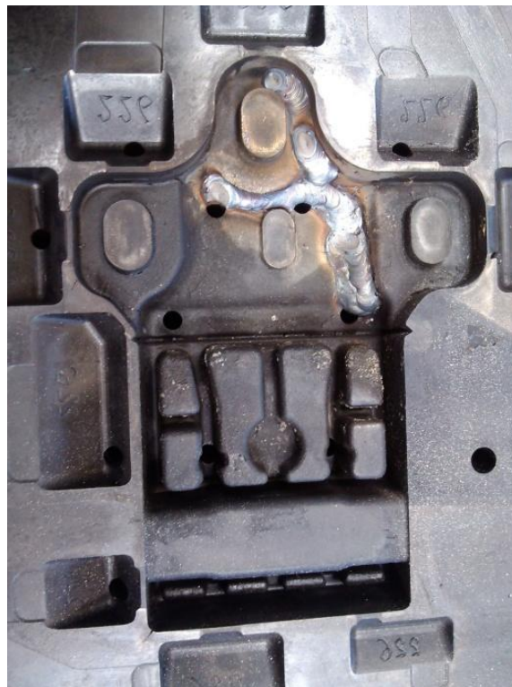
Slika 11. Popravak kalupa TIG navarivanjem - primjer 1 [1]
