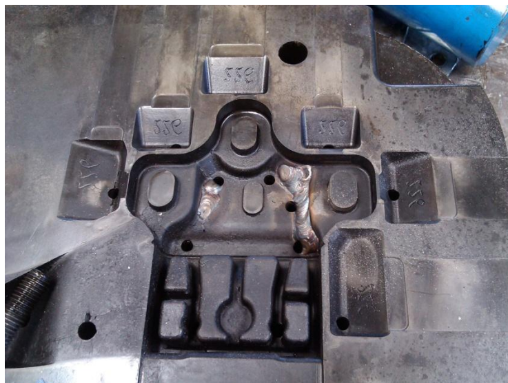
Slika 12. Popravak kalupa TIG navarivanjem - primjer 2 [1]
