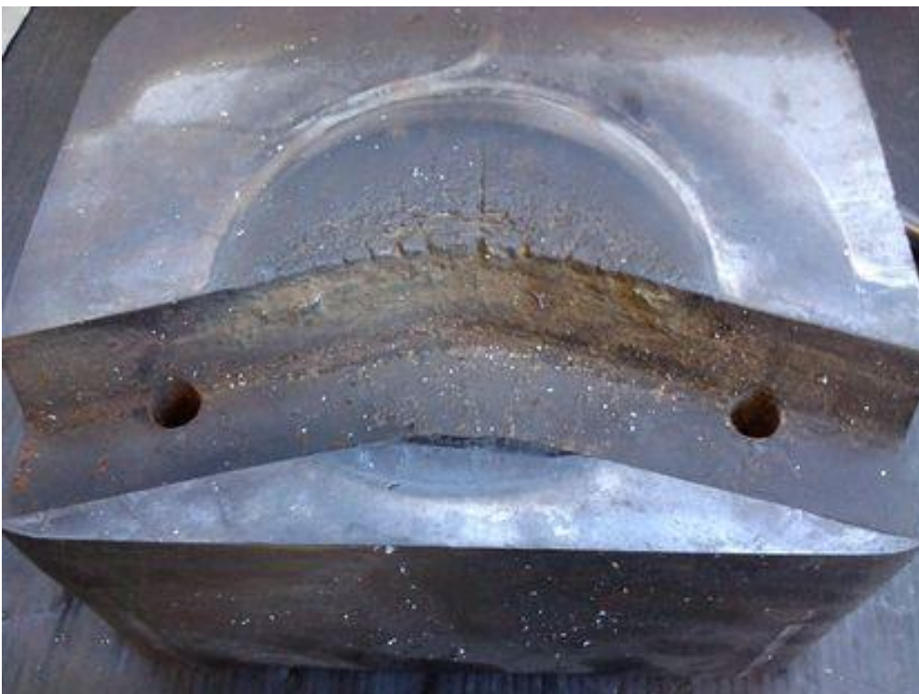
Slika 7. Trošenje materijala kalupa pri procesu lijevanja - primjer 2 [1]
