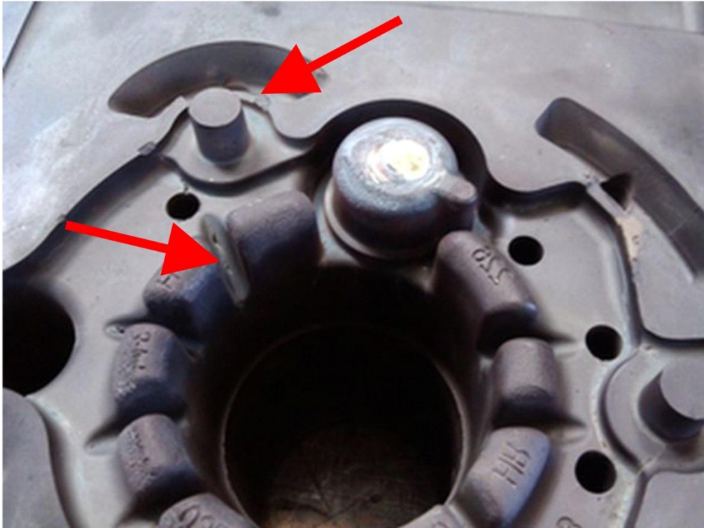
Slika 6. Trošenje materijala kalupa pri procesu lijevanja - primjer 1 [1]
