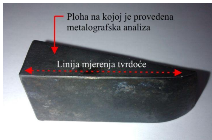
Slika 26. Uzorak čelika iz tvornice LTH za metalografsku analizu i ispitivanje tvrdoće
