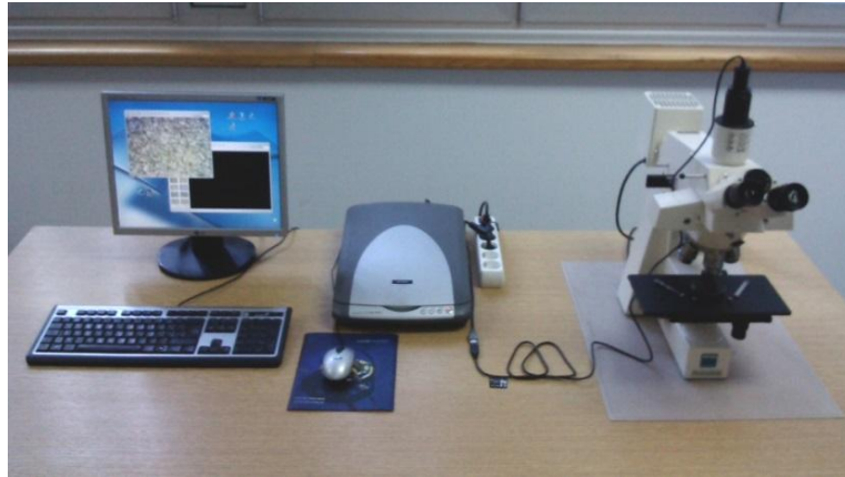
Slika 31. Laboratorijska oprema za metalografsku analizu uzoraka - FESB Split [12]
