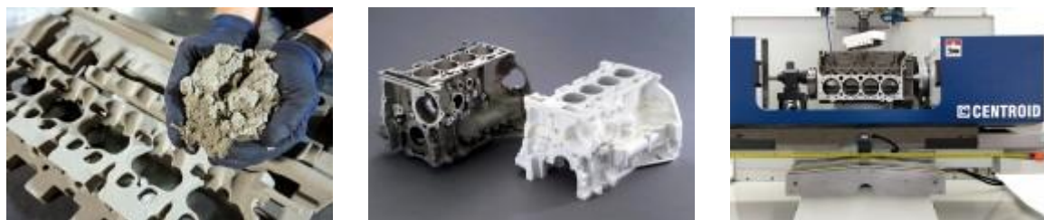
Slika 5. Primjeri različitih proizvodnih postupaka izrade bloka motora: pješčani lijev BMW AG (lijevo), isparivi model - lijevo je gotovi aluminijski blok, a desno polistirenski uložak kalupa - “pozitiv“ odljevka, General Motors (sredina), CNC glodalica za izradu bloka motora, Centroid Corporation (desno) [4]
