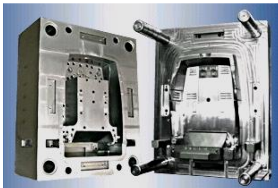
Slika 16. Primjer čeličnog kalupa za tlačni lijev tvrtke Tontye Technologies Co., Ltd.
