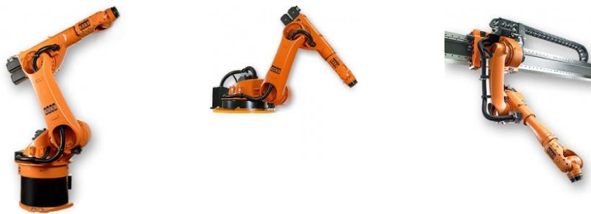
Slika 18. Roboti za prihvrat i hlađenje odljevaka, modeli KUKA [10]
