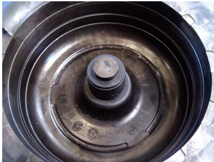
Slika 24. Trošenje materijala kalupa pri procesu lijevanja (tope pukotine) [12]
