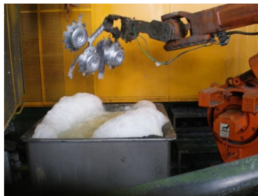
Slika 17. Robotizirani uređaj za prihvata i hlađenje odljevaka [9]
