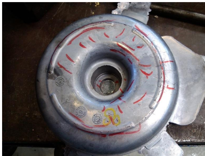
Slika 25. Učinak istrošenosti kalupa na odljevak (označeno crvenim linijama) [12]
