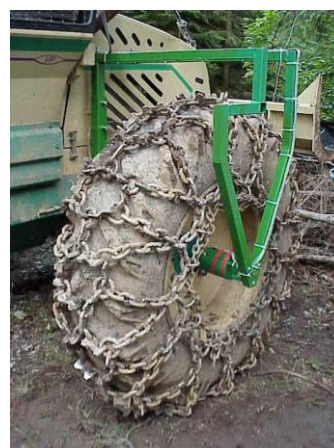
Slika 16. Klizni prijenosnik na kotaču skidera Woody 110
