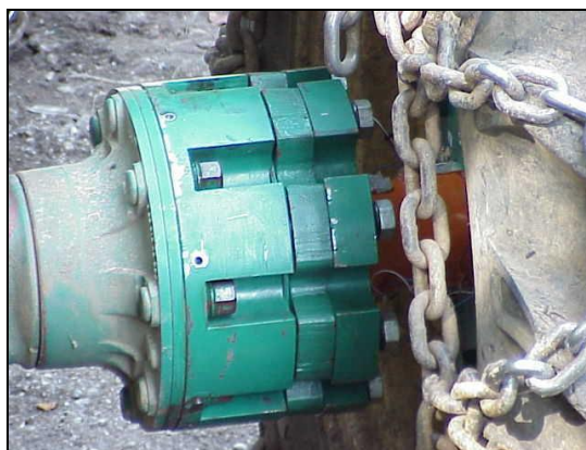
Slika 12. Ugrađeni dinamometar sa ugrađenim mjernim trakama za mjerenje zakretnih momenata i opterećenja na kotačima skidera Woody 110
