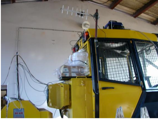
Slika 19. Pojačala, radio modem i antena na skideru Ecotrac 120 V
