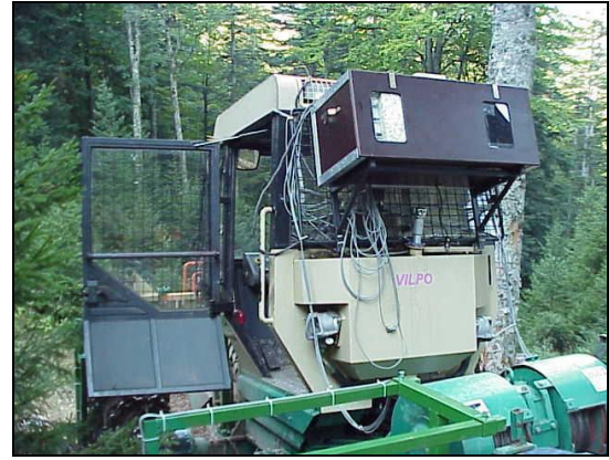
Slika 20. Pojačala i računalo na skideru Woody 110
