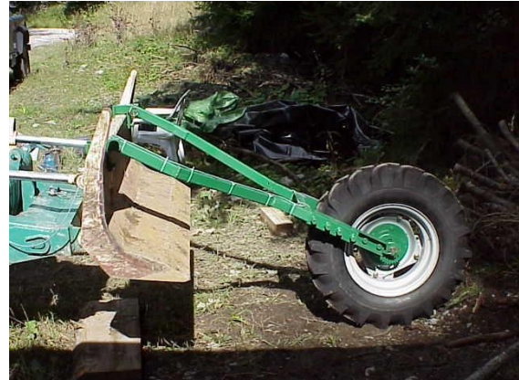
Slika 18. Peti kotač na skideru Woody 110
