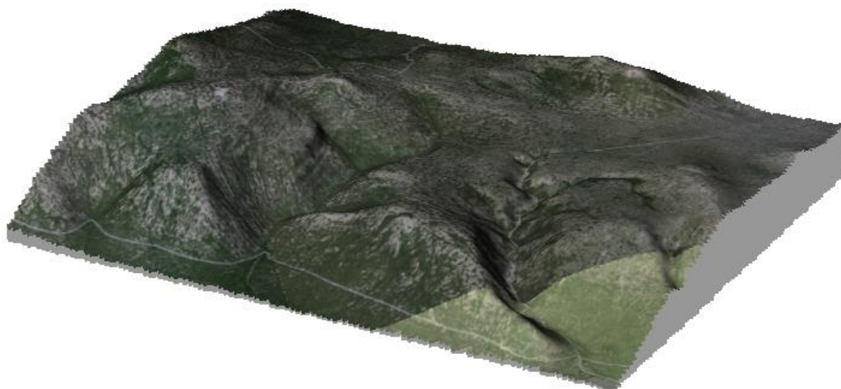
Sl. 80. DOF preklopljen preko optimalnog DMR-a (OKK – E)
