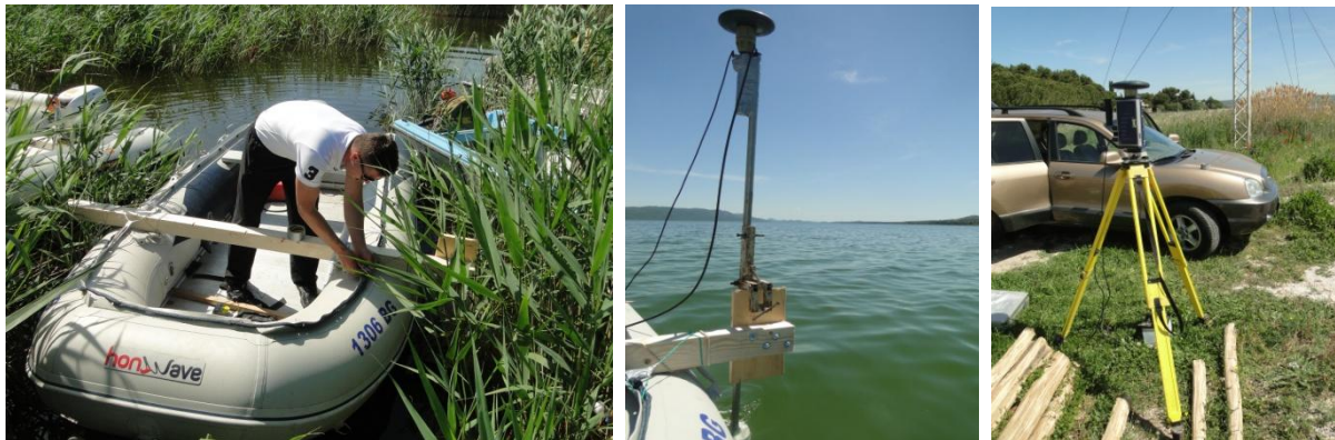
Sl. 18. Korišteni gumenjak Hondawave s montiranim drvenim nosačem
