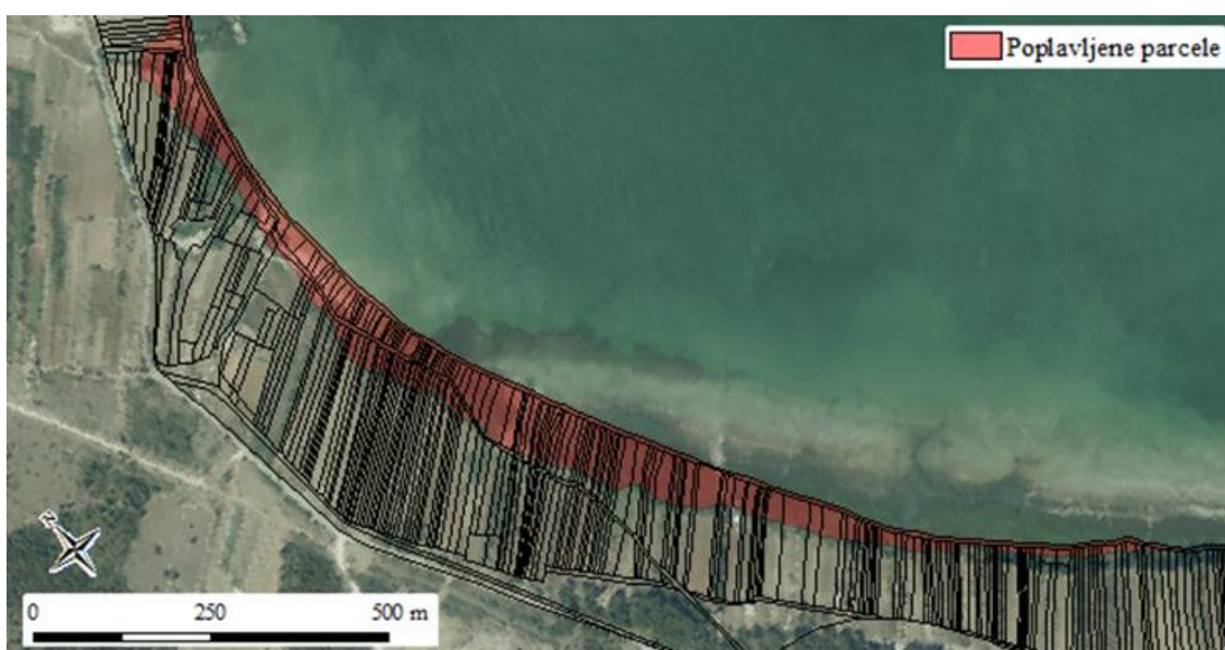
Sl. 44. Poplavljene poljoprivredne parcele u K.O. Pakoštane pri vodostaju od 2 metra (sjeverozapadni dio Parka)
