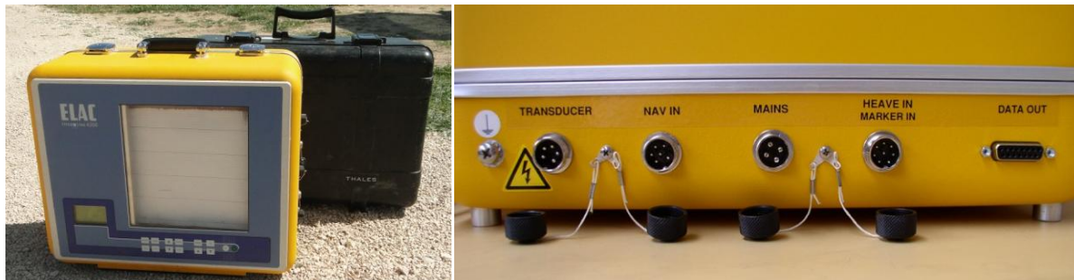
Sl. 22. Dubinomjer Hydrostar 4300
