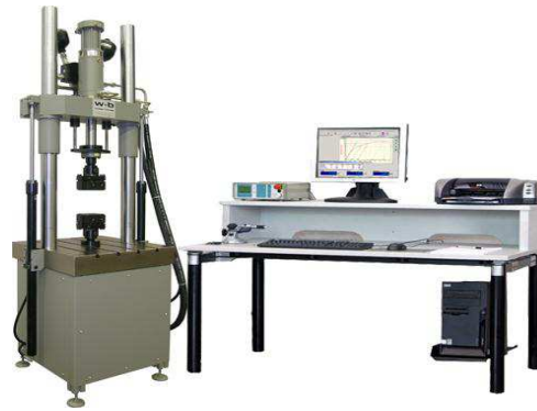
Slika 3. Servohidraulička umaralica LFV 50-HH s upravljačkom jedinicom Fig. 3 The hydraulic testing machine LFV 50-HH with control unit
