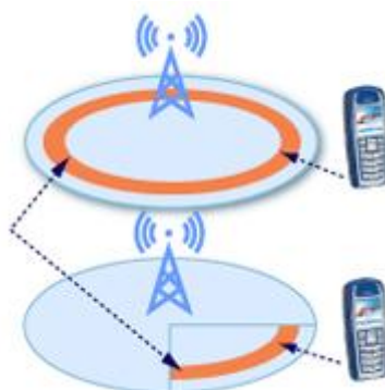
Slika 3-2: Neusmjereno i usmjereno lociranje mobilnog terminala u GSM mreži [17]
