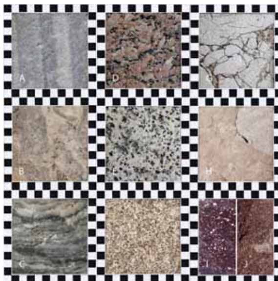
Sl. 2. Vrste dekorativnog kamena korištenog za stupove Dioklecijanove palače (foto Z. Sunko)
