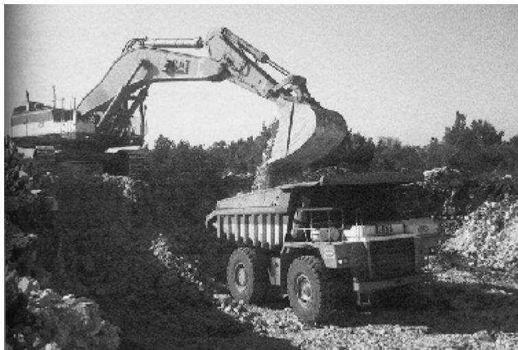
Slika 1. Bager CAT 375L pri utovaru kamenog materijala
