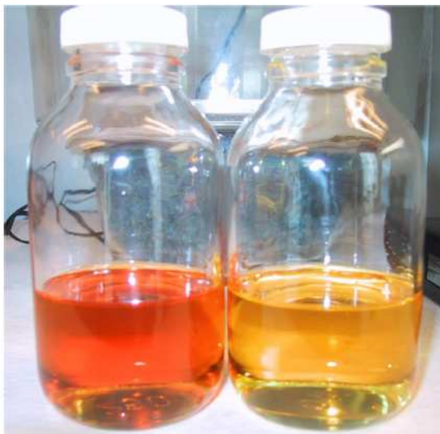
Slika 11 Transformatorsko ulje – staro i novo
