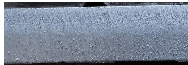
p: 6 bar, v: 4000 mm/min, I: 100 A, H: 1 mm
