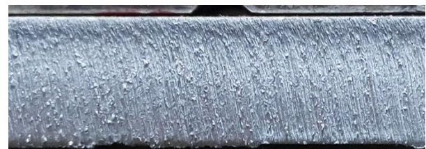
p: 7 bar, v: 4000 mm/min, I: 100 A, H: 1 mm
