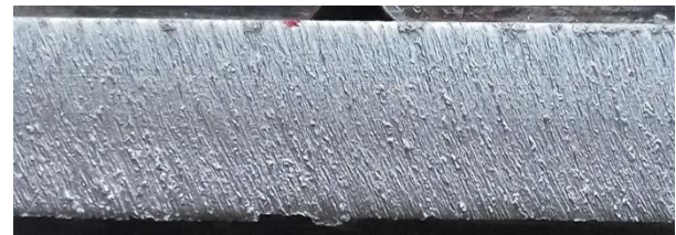
p: 5 bar, v: 4000 mm/min, I: 85 A, H: 2 mm
