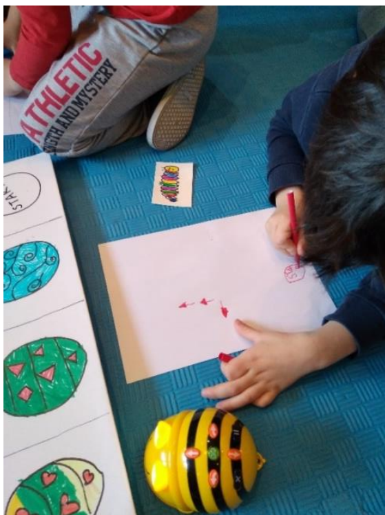
Slika 14. Određivanje cilja i pisanje algoritma Slika 15. Programiranje Bee Bot-a prema zapisanom algoritmu
