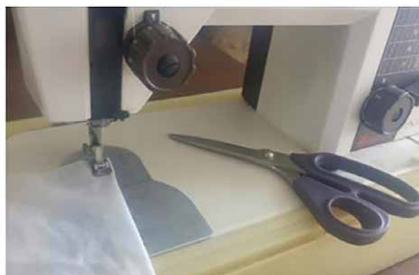
Slika 15. Prikaz izrade utega od olovne sačme korištenih za opterećenje rezbarenih površina prilikom podljepljivanja. Foto: Alma Dilberović.
