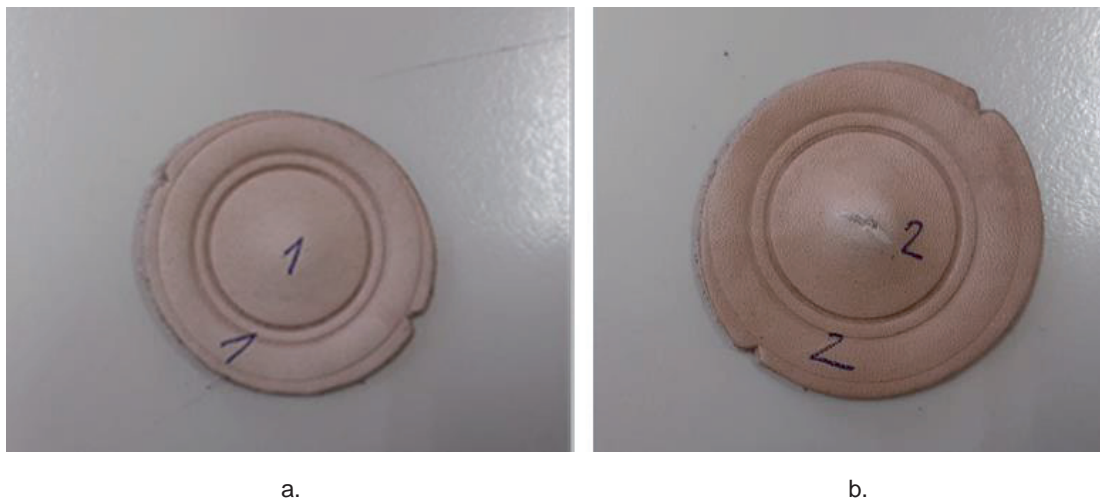
Slika 1: Uzorci kože nakon ispitane otpornosti na pucanje: a. uzorak VEG; b. uzorak VEG+Z
