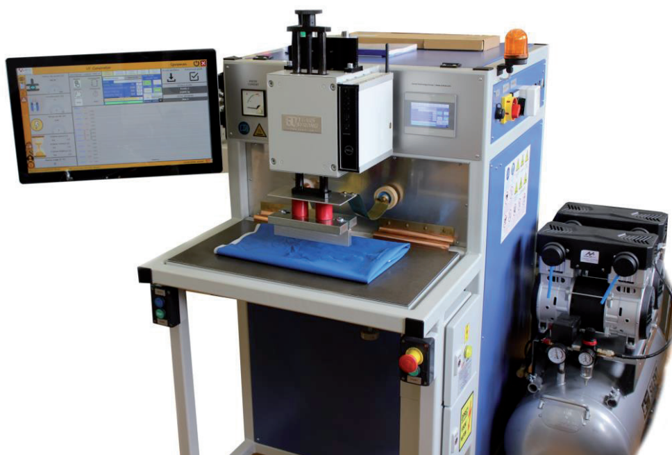
Slika 1: Stroj za visokofrekventno spajanje termoplastičnih polimernih materijala tvrtke Zemat oznake Depta
