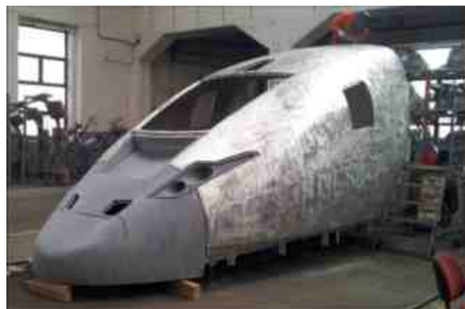
Prototip njemačkog brzog vlaka ICE od zavarenog sendviča s upjenjenom aluminijevom jezgrom
