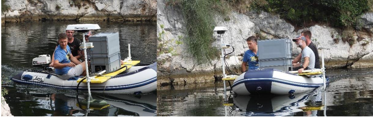
Slika 16. Gumenjak Luna na kojem je instaliran integralni mjerni sustav
