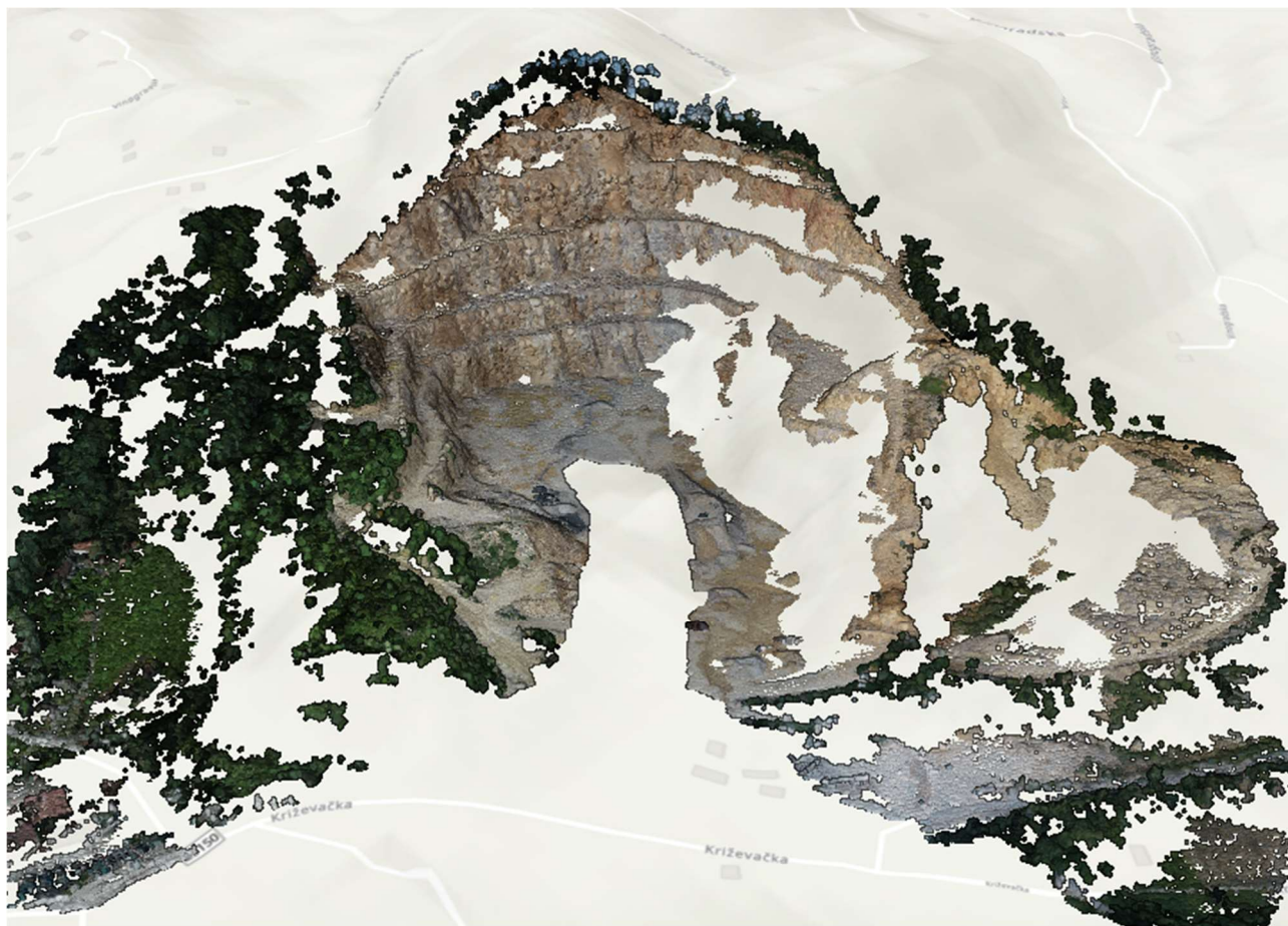
Slika 73 . Oblak točaka-vertikalno snimanje kamenoloma
