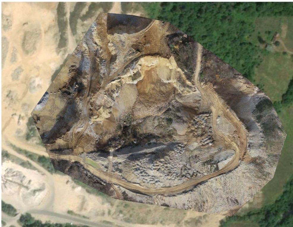
Slika 55. Ortomozaik-crosshatch snimanje otpada
