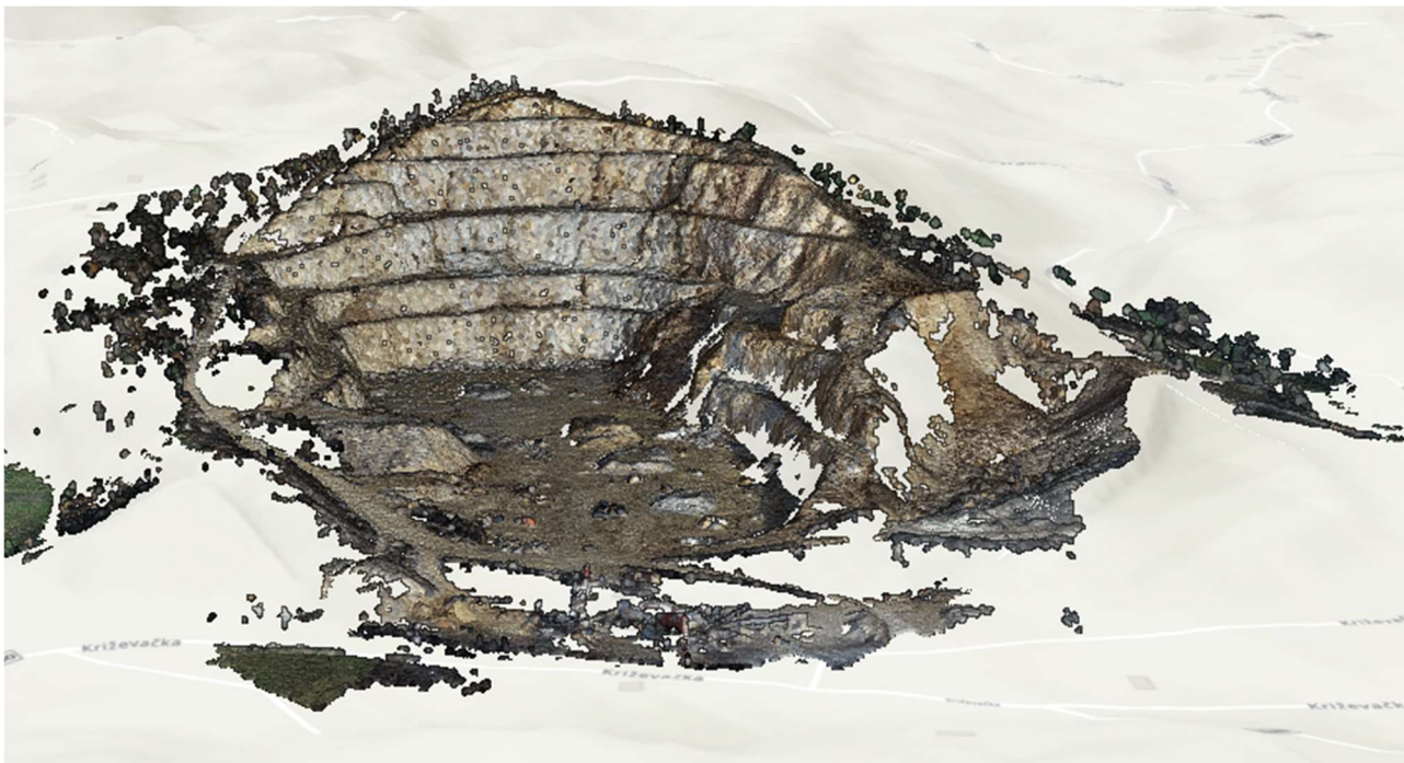
Slika 64. Oblak točaka Drone2Map-crosshatch snimanje kamenoloma
