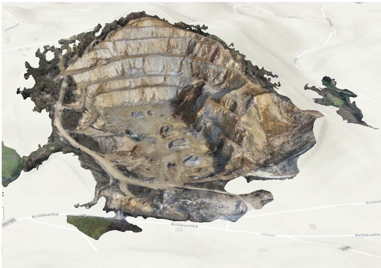
Slika 65. 3D model- crosshatch snimanje kamenoloma
