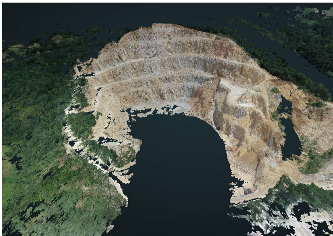
Slika 53. Oblak točaka-vertikalno snimanje (uvećanje)
