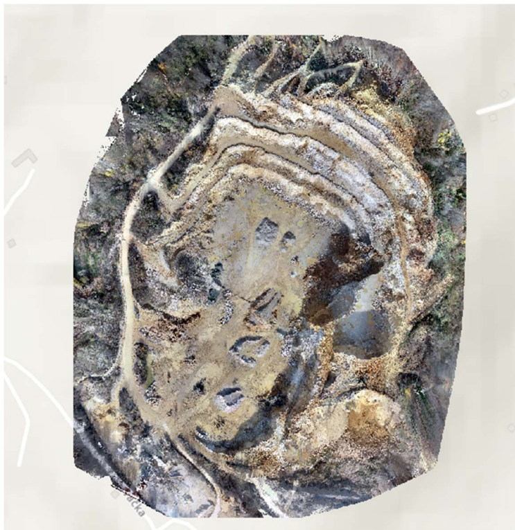
Slika 61. Ortomozaik Drone2Map-crosshatch snimanje kamenoloma
