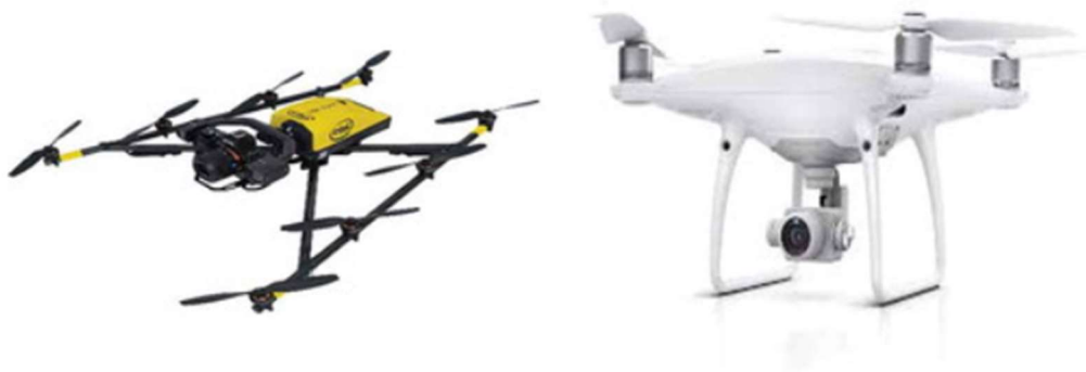
Slika 5. Multikopteri-AscTech Falcon i DJI Phantom
