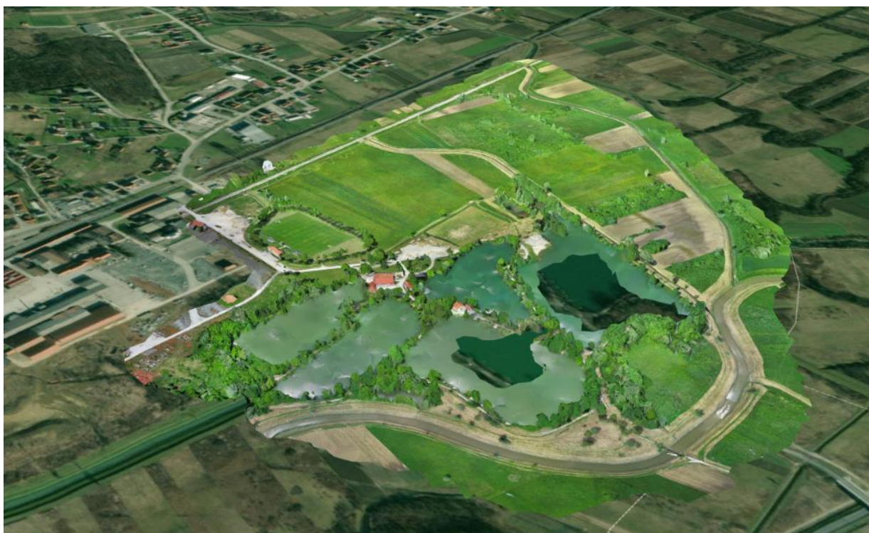
Slika 39. 3D model područja dobivenog površinskom metodom u Site Scan-u
