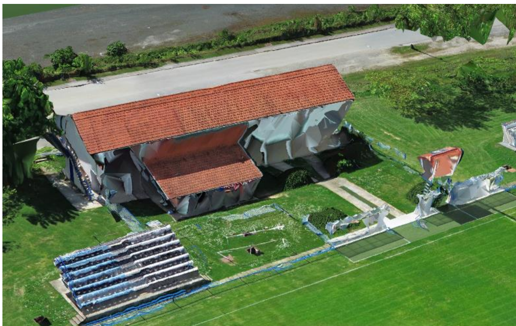
Slika 45. Detalj 3D modela dobivenog površinskom metodom
