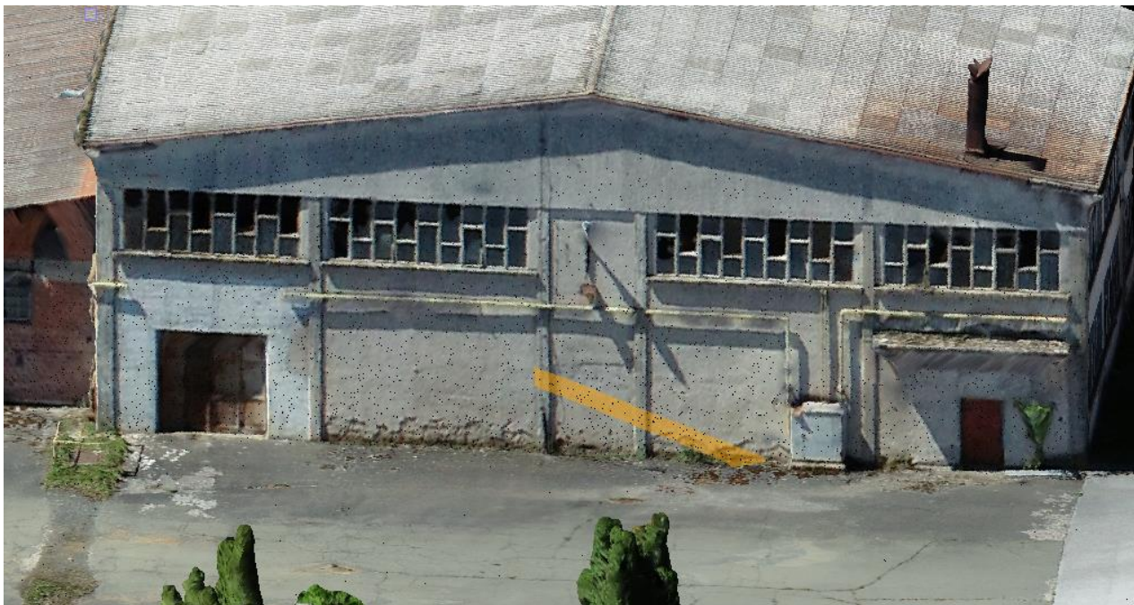
Slika 123. Detalj oblaka točaka snimljenog dvostrukom metodom u CCM softveru
