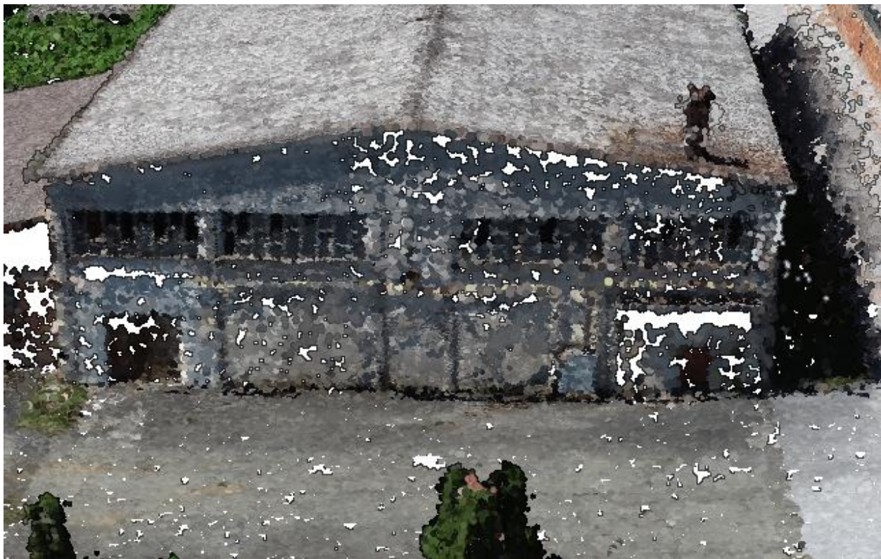
Slika 125. Detalj oblaka točaka snimljenog dvostrukom metodom u D2M softveru
