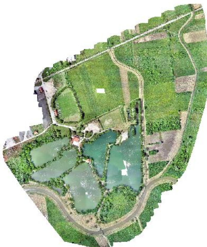
Slika 64. Ortomozaik dobiven površinskom metodom u D2M softveru
