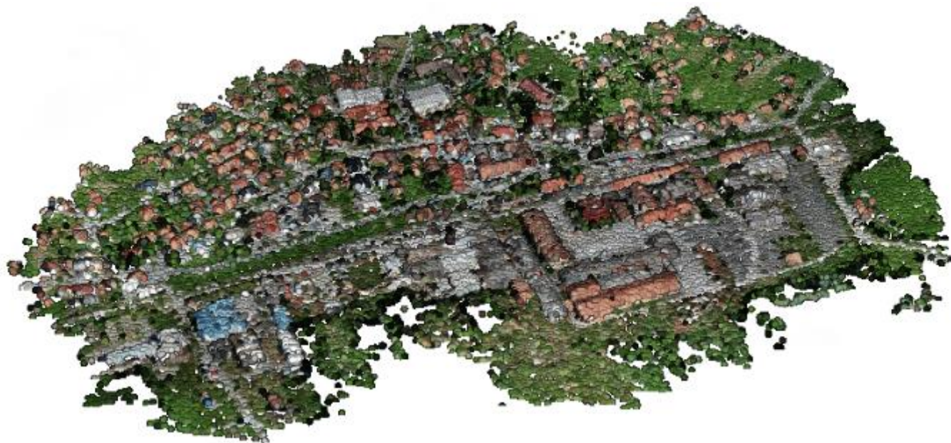
Slika 69. Oblak točaka dobiven dvostrukom metodom u D2M softveru
