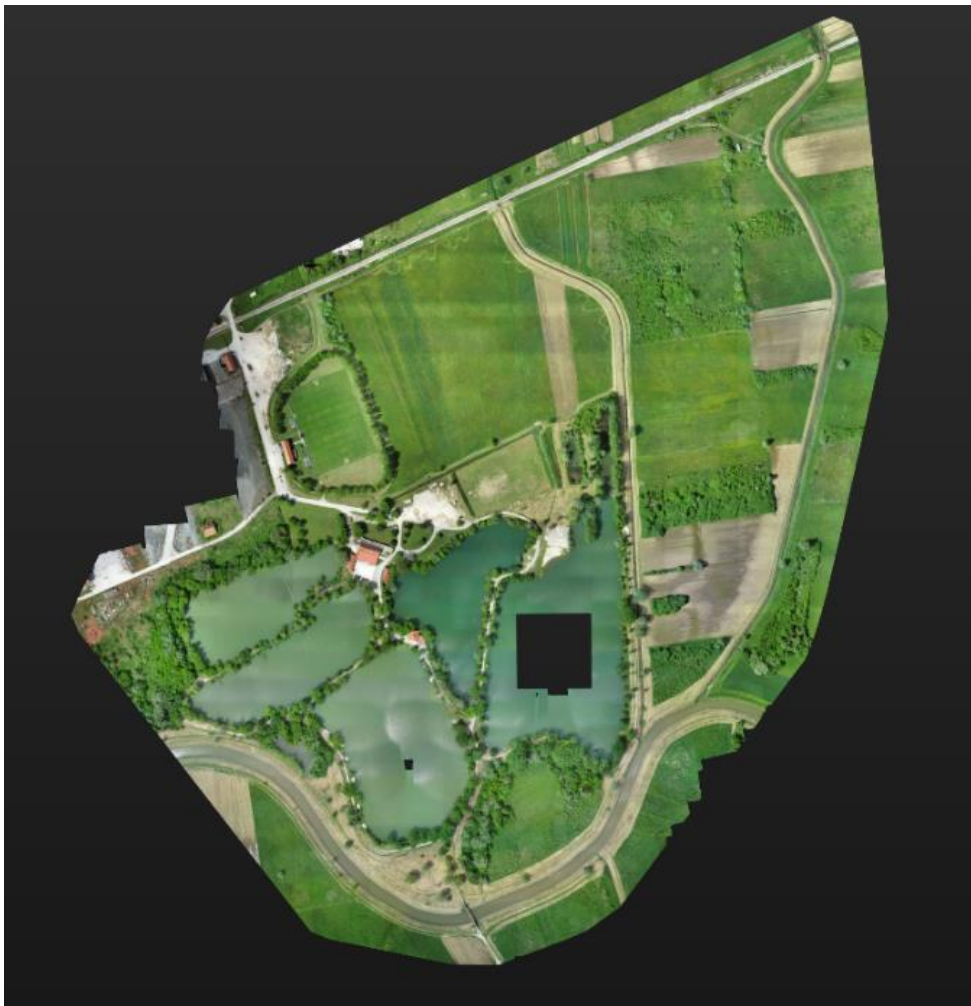
Slika 36. Ortomozaik područja dobivenog površinskom metodom u Site Scan-u
