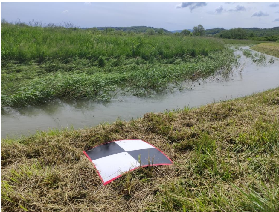
Slika 18. Zemaljska kontrolna točka (GCP)
