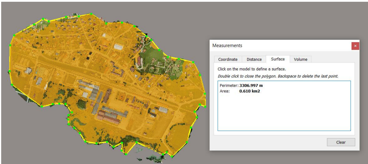
Slika 114. Funkcija mjerenja površine u CCM Viewer-u
