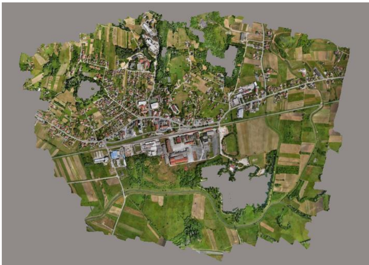
Slika 108.3D Model dobiven iz snimki eBee letjleice u CCM softveru
