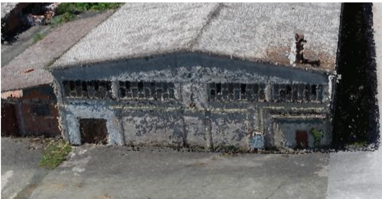
Slika 124 Detalj oblaka točaka snimljenog dvostrukom metodom u Site Scan softveru
