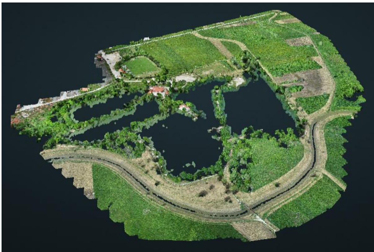
Slika 38. 3D oblak točaka područja dobivenog površinskom metodom u Site Scan-u
