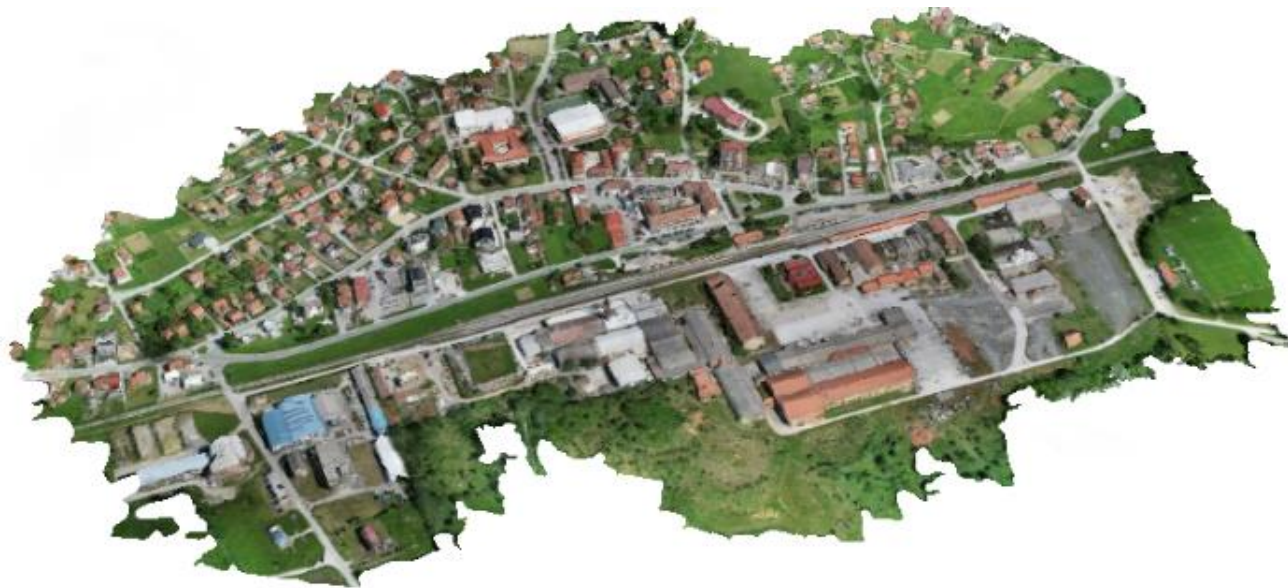
Slika 73. 3D model snimljen dvostrukom metodom u D2M softveru
