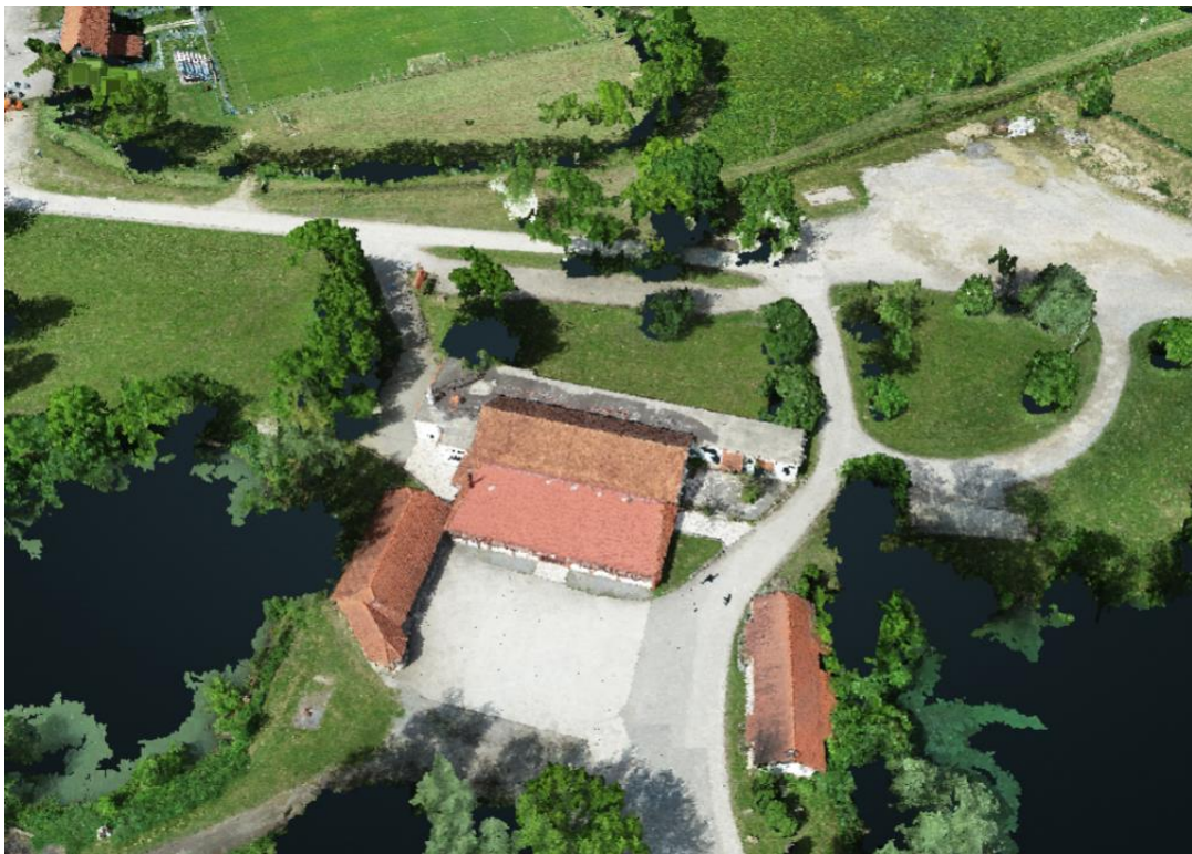
Slika 43. Detalj oblaka točaka dobiven površinskom metodom u Site Scan-u
