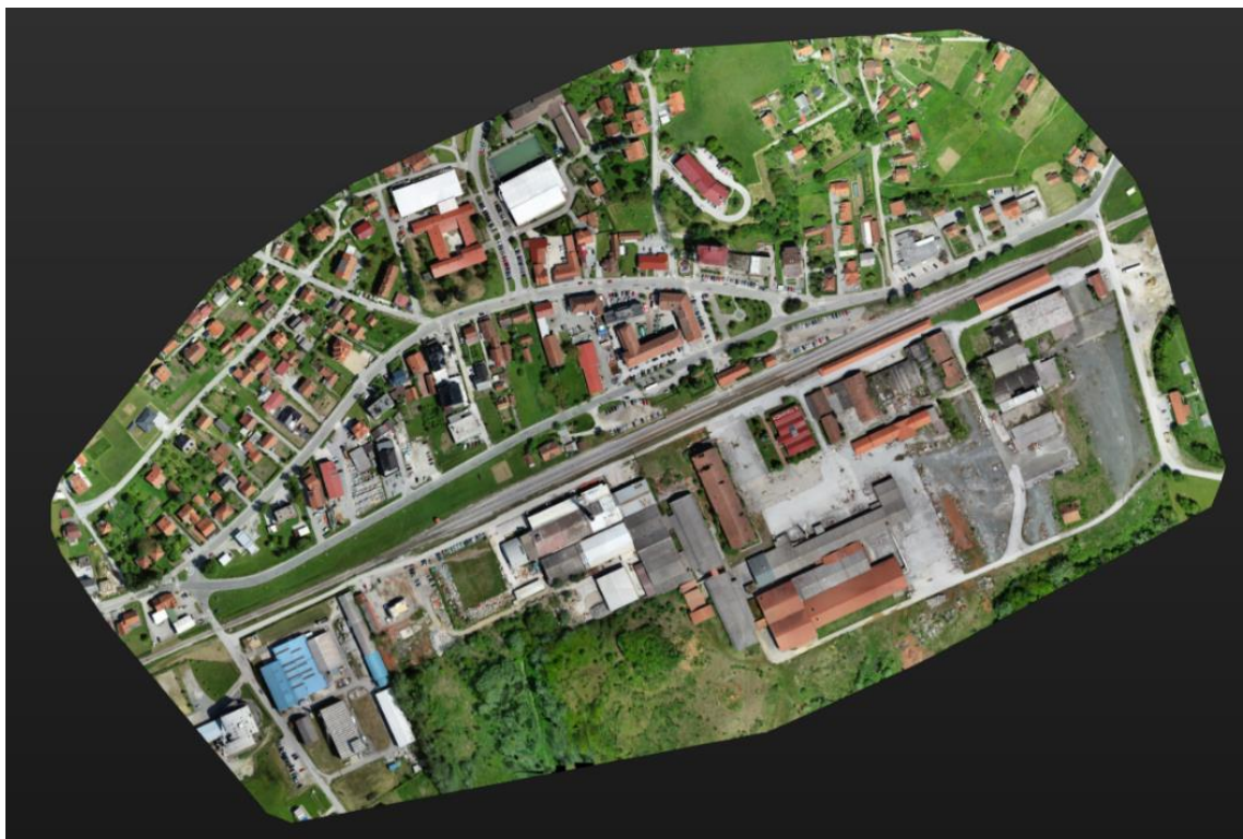
Slika 29. Ortomozaik područja dobivenog isprekidanom metodom u Site Scan-u
