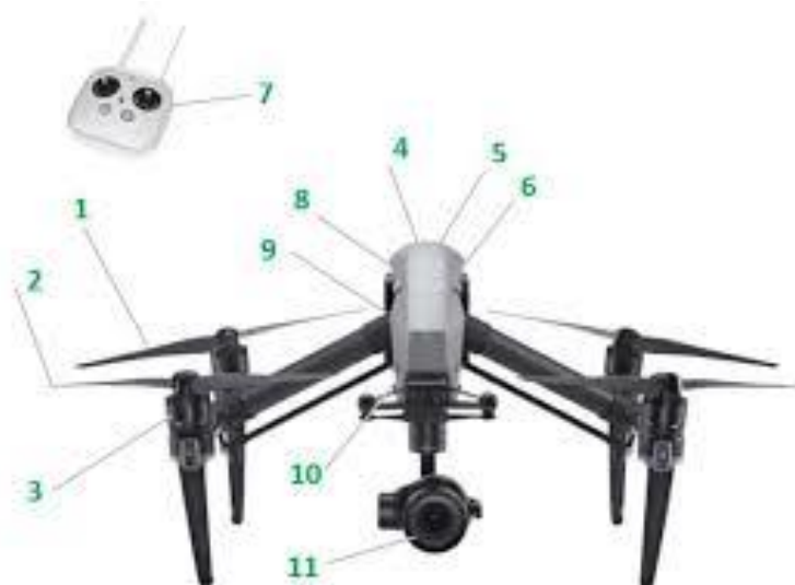
Slika 9. Dijelovi dronova drona (URL 9) (1- standardni propeleri, 2- potisni propeleri, 3- motor bez četkica, 4- oprema za slijetanje, 5- elektronički regulatori brzine, 6- kontrolor leta, 7- prijemnik, 8- odašiljač, 9- GPS komponenta, 10- baterija, 11- kamera)
