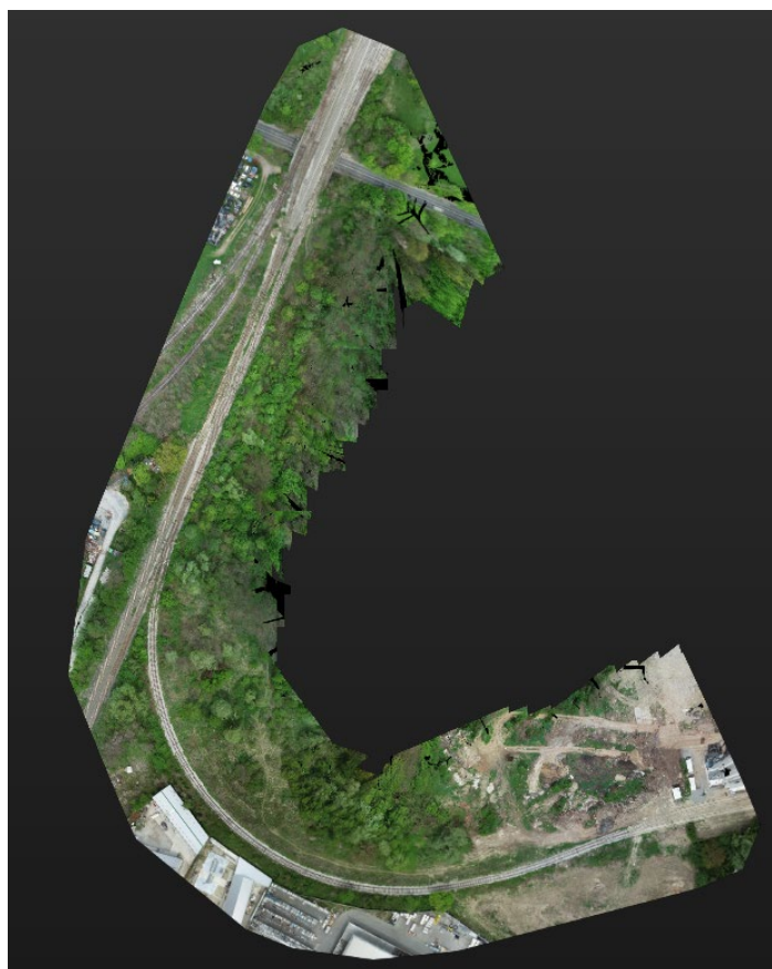
Slika 7.2 Dobiveni ortofoto prikaz pruge u Site Scan-u
