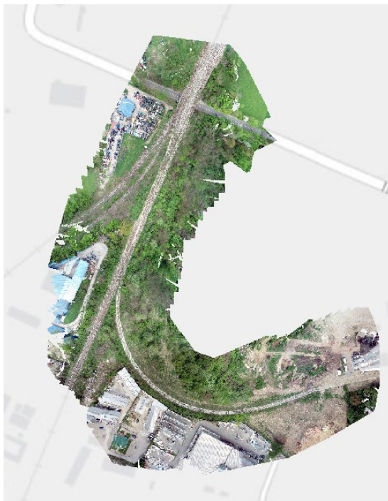
Slika 7.12 Dobiveni ortofoto prikaz pruge u Drone2Map-u
