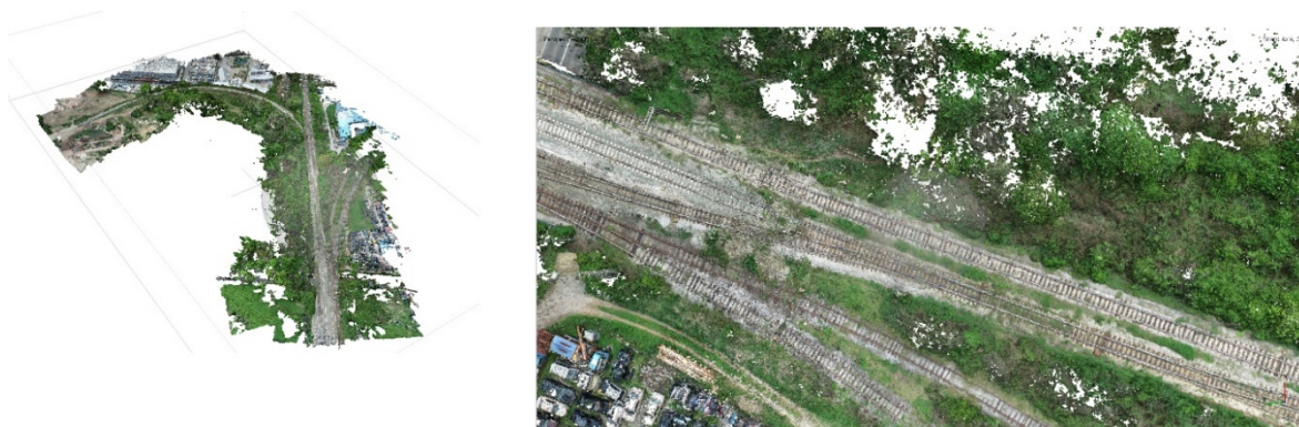
Slika 7.24 Dobiveni point cloud pruge u Agisoft Metashape Pro-u
