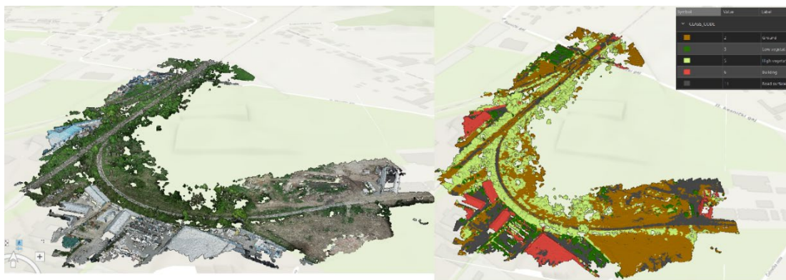
Slika 7.14 Dobiveni point cloud pruge (lijevo) i klasificirani point cloud pruge (desno) u Drone2Map-u
