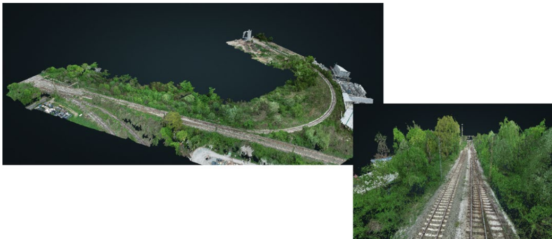
Slika 7.4 Prikaz point clouda pruge dobiven u Site Scan-u (lijevo) i uvećani prikaz trase (desno)
