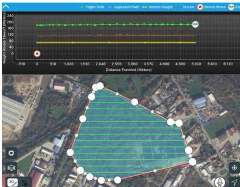
Slika 6.6 2D prikaz putanje leta- area način s uključenom geofence i terrain follow opcijom
