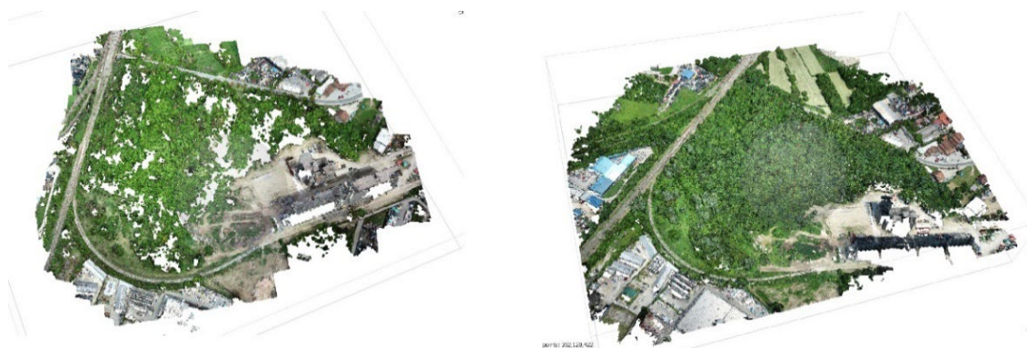
Slika 7.28 Dobiveni dense cloud šume u Agisoft-u za snimanje 30.4.2021 (lijevo) i snimanje 2.6.2021 (desno)
