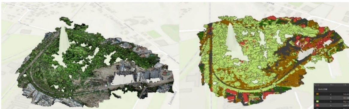
Slika 7.18 Dobiveni point cloud šume (lijevo) i klasificirani point cloud šume (desno) u Drone2Map-u za snimanje 30.4.2021.
