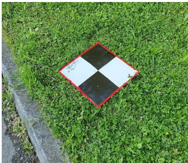
Slika 5.5 Signalizacijska oznaka na kontrolnoj točki
