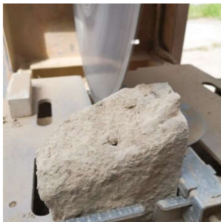
Slika 1. Rezanje uzoraka iz velikih komada nabijene zemlje
