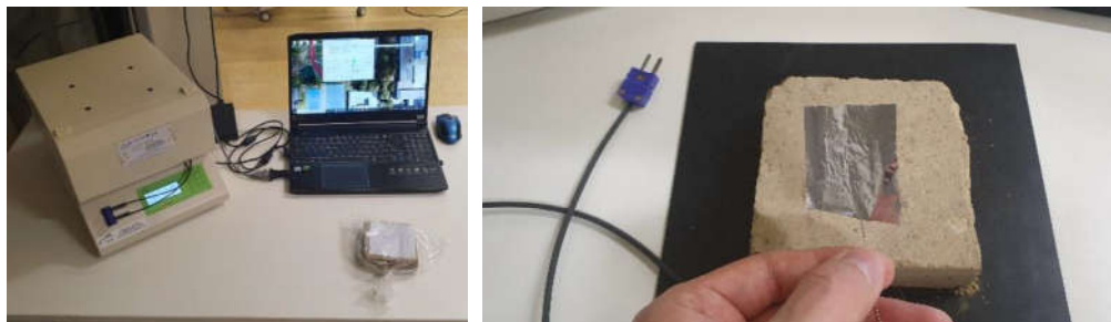
Slika 2. Uređaj (lijevo) i uzorak (desno) za ispitivanje koeficijenta toplinske provodljivosti
