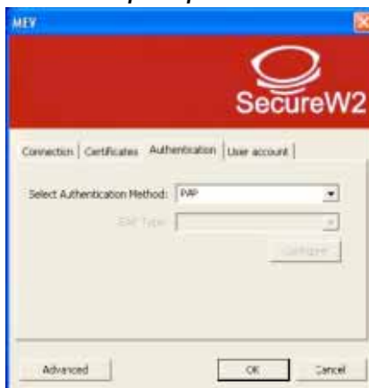
SLIKA 2: PAP protokol koji se koristi na Međimurskom veleučilištu za provjeru korisnika za pristup na EDUROAM bežičnu mrežu
