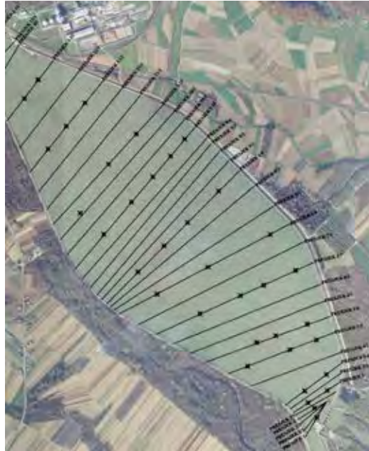
Slika 2. Položaj hidrografskih profila i pozicija uzimanja uzoraka nanosa u akumulaciji HE Varaždin
