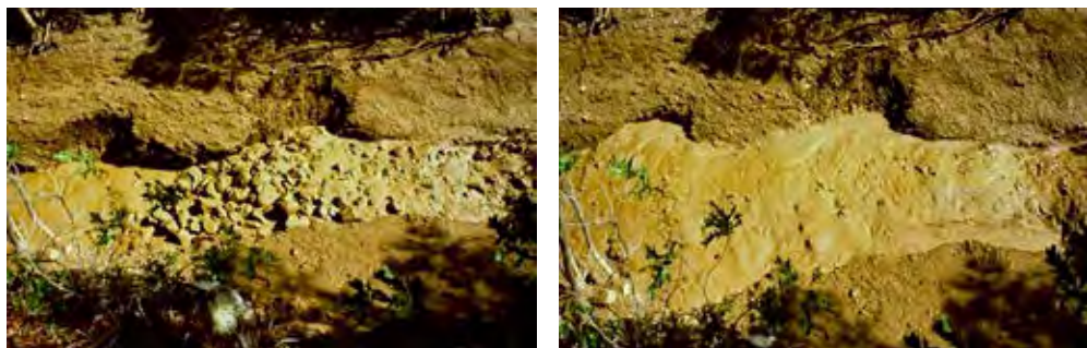
Slika 2. Klasični prikaz toka a) krupnozrnatog i b) sitnozrnatog materijala (Žic, 2015)
