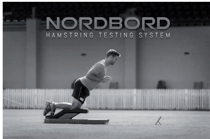
Slika 7. Mjerenje ekcentrične jakosti prilikom izvođenja Nordijskog pregiba putem NordBorda™ (Vald Performance)
