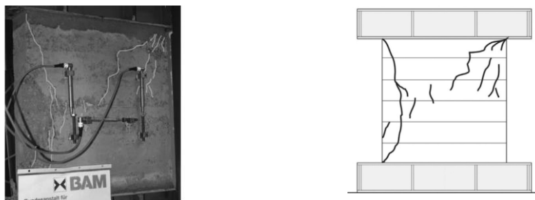
Slika 4. Uzorak pukotina zida opterećenog vertikalnim opterećenjem [7] (uredili autori)
