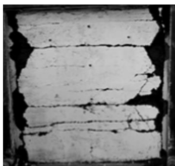
Slika 1. Zid od nabijene zemlje ispitivan na horizontalno cikličko djelovanje [4] (uredili autori)
