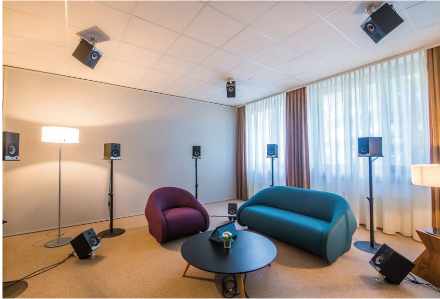
Figure 1 – Ambisonics listening room in TGM Fachbereich für Akustik und Bauphysik in Vienna
