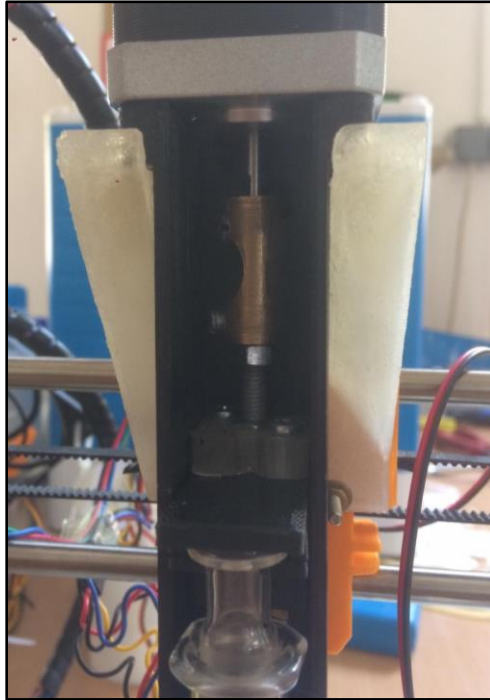
Slika 12. Dodatni nastavak za pritiskanje klipa te dio od mesinga za mehanički prijenos.
