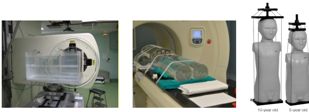
Slika 1. Korišteni fantomi: vodeni fantom (lijeva slika), BOMAB-u slični fantom (srednja slika) i antropomorfnji dječji fantomi (CIRS, Inc., Norfolk, VA, USA) koji prikazuju desetogodišnje i petogodišnje dijete (desna slika)
