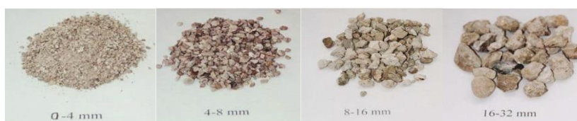
Slika 5. Stari beton nakon prerade (frakcije recikliranog agregata) [4].
