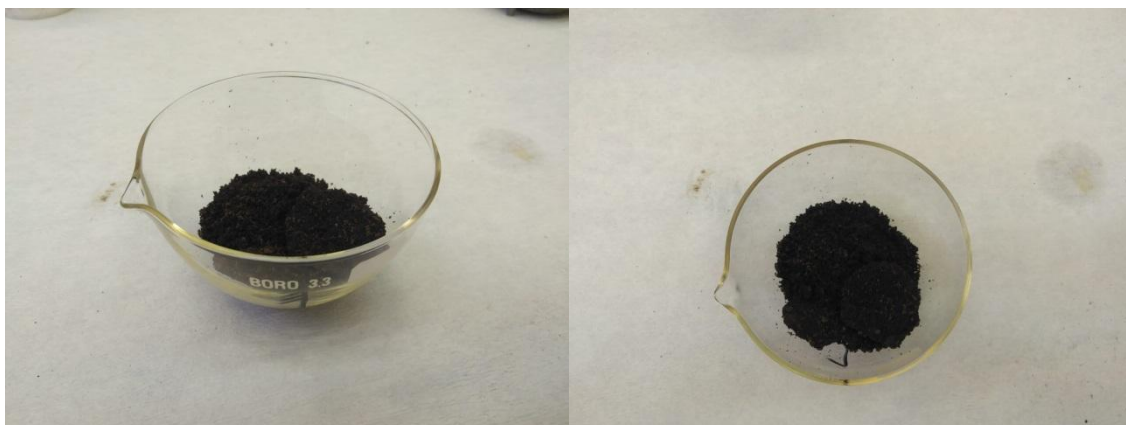
Slika 7: Geopolimer 1 nakon sušenja u labaratorijskoj pećnici 24 h
