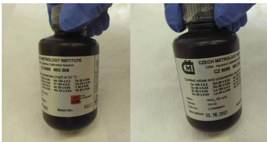
Slika 9: Referentni standard elemenata rijetkih zemalja s prikazanim vrijednostima elemenata
