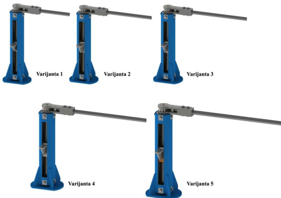
Sl. 9. Familija proizvoda parametarskog modela ručne dizalice
