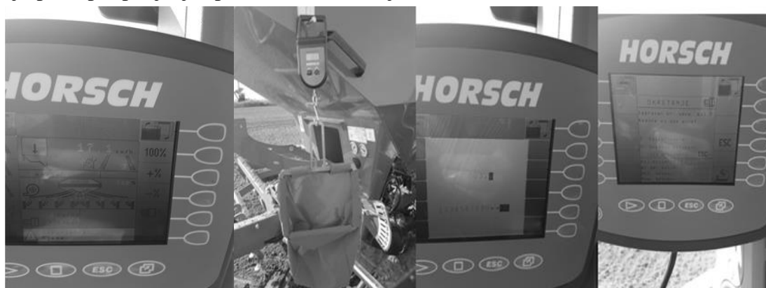
Slika 3.a. Zaslon računala sijačice „Horsch Pronto 6 DC“, 3b. Kalibracija sjemena (Izvor: Šarić, 2016.)
