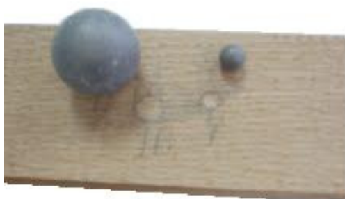
Slika 2. Kugla iz CM uređaja i utisak kugle po RVU (lijevo); kuglica i utisak po Brinell-u (desno)
