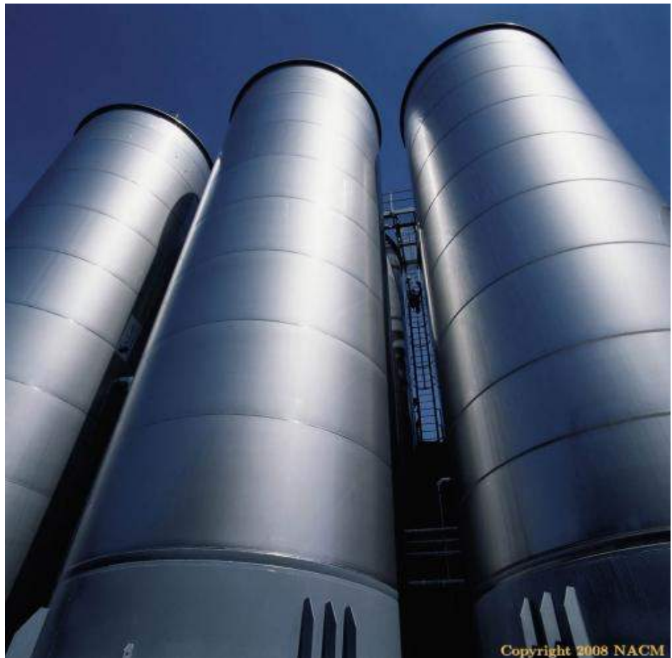
Slika 16 - Tankovi od nehrđajućeg čelika za čuvanje jabučnoga vina (fotografija ustupljena od The National Association of Cider Makers (Velika Britanija))
