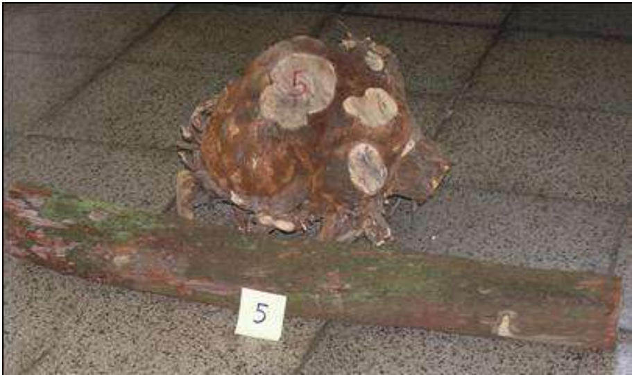
Figure 3 Briarwood and trunk wood (Erica arborea L.)
