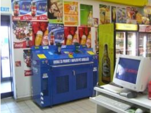
Slika 2. Uređaj za automatsko prikupljanje ambalažnog otpada.
