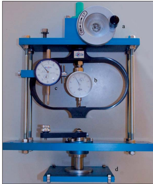
Slika 5. Gornji dio prijenosnog uređaja za izravni posmik
