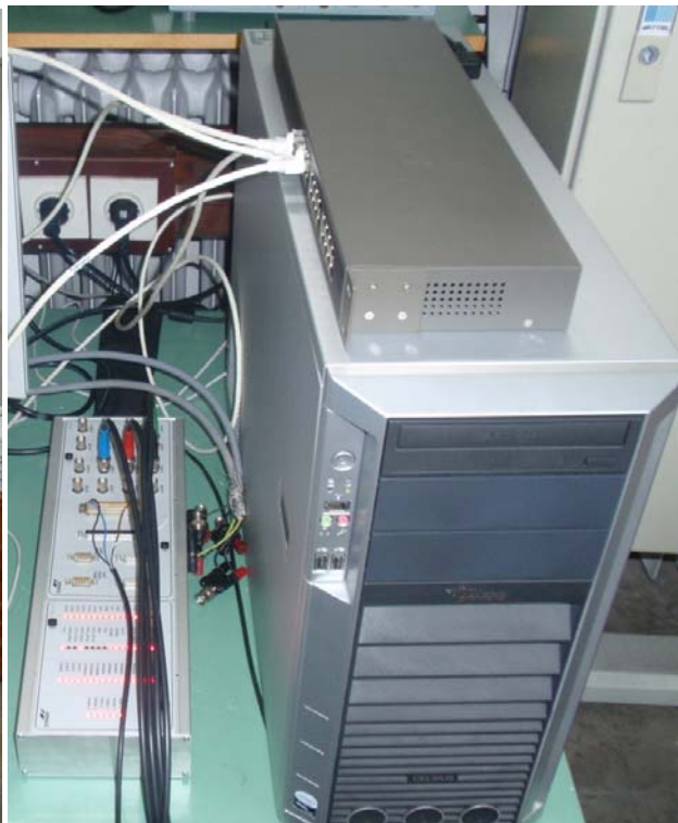
Slika 5. Desktop računalo sa HIL simulatorom STR; lijevo dSPACE-ova konektorska ploča za povezivanje ispitivanog regulatora i simulatora
