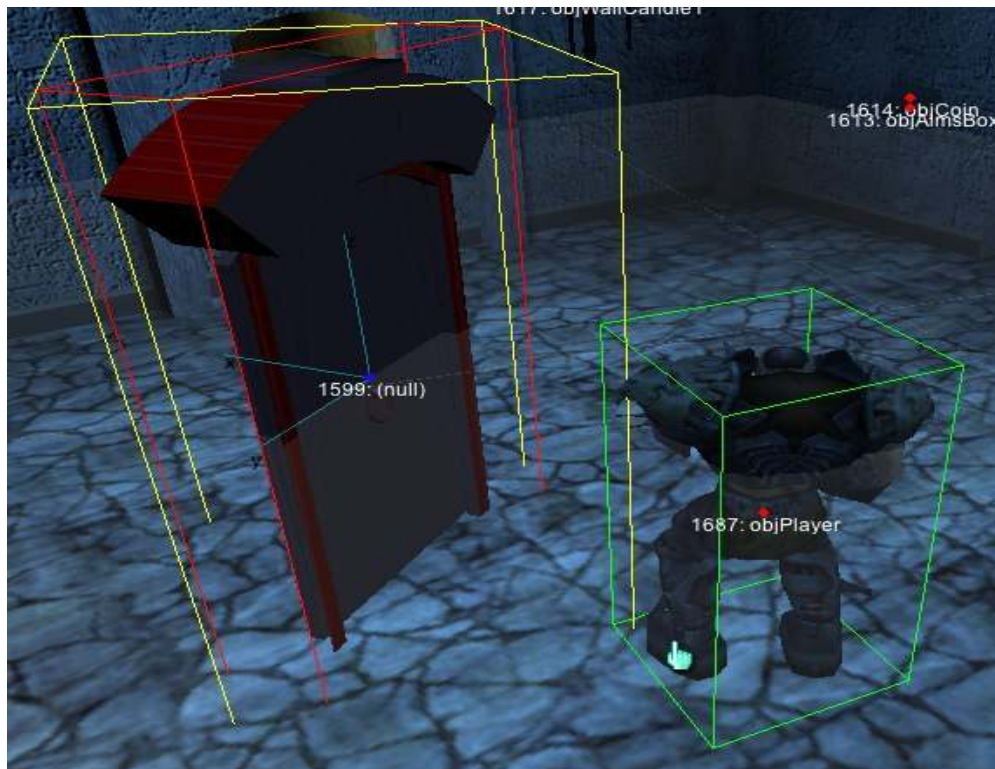
Slika 9. Objekti s kvadrima obujmicama za detekciju sudara.
